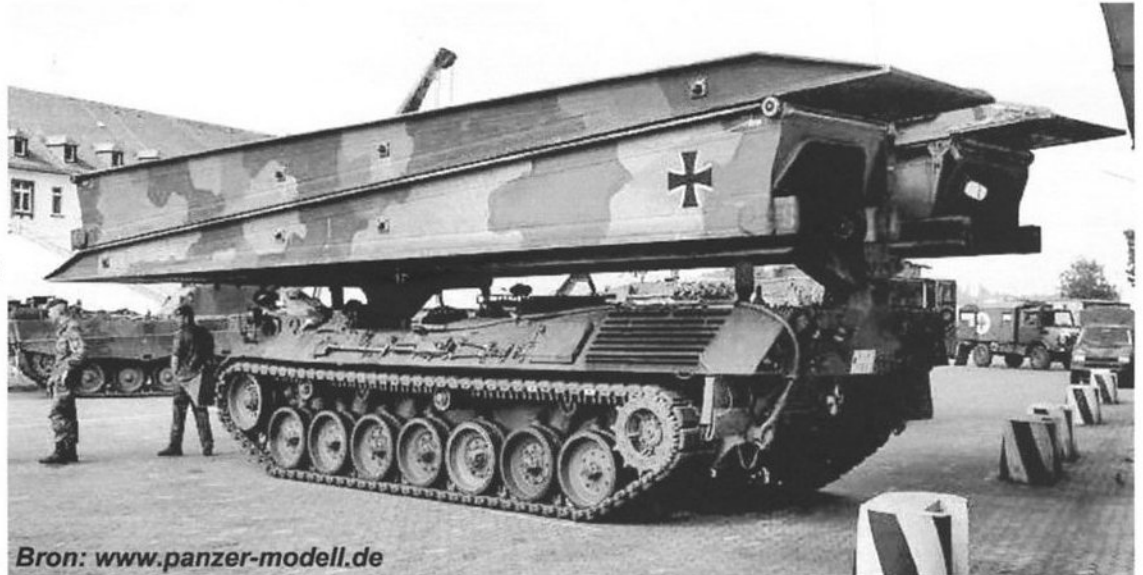
Bruggertank Biber met over elkaar schuivende brugdelen.
