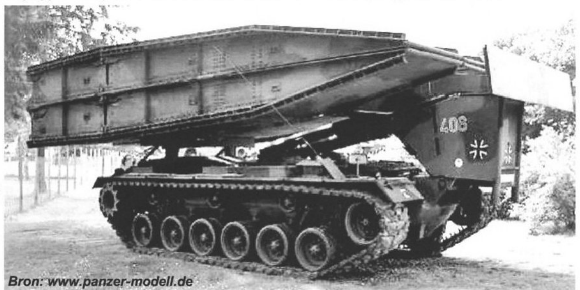
Bruggertank M48 met schaarbrug.
